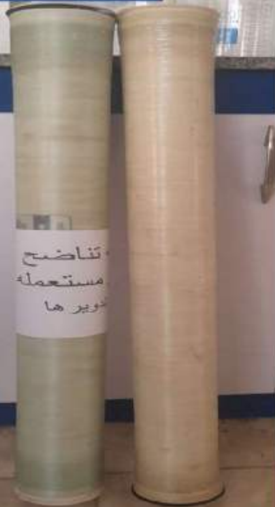
Old RO membranes
